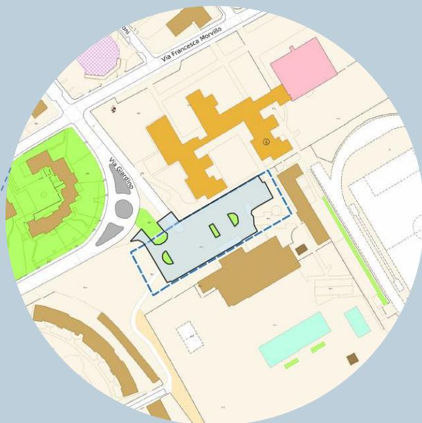
Nuovo sistema di drenaggio di piazza Bianchi basato su trincee drenanti, aree di bioritenzione e pozzi di infiltrazione e disconnessione dalla rete fognaria.
