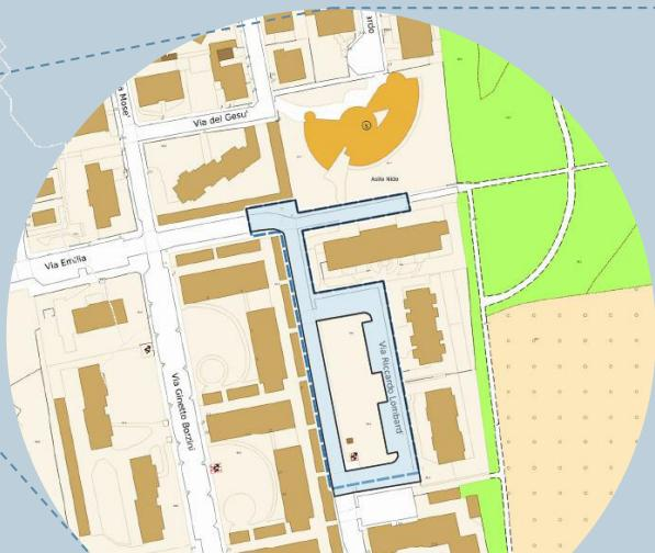
Disconnessione dalla rete fognaria di 3600 metri quadri di superfici stradali mediante ricorso ad aree di bioritenzione e pozzi di infiltrazione in via Emilia - via Lombardi
